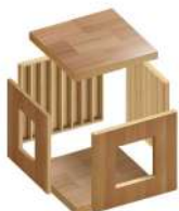
6面体で作る モノコック構造
