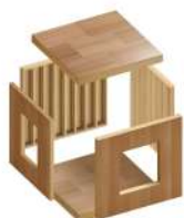
6面体で作る モノコック構造
