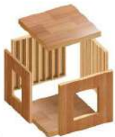
6面体で作る モノコック構造
